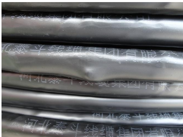
高压线缆材料中出现接头
