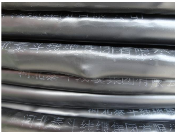
高压线缆材料中出现接头
