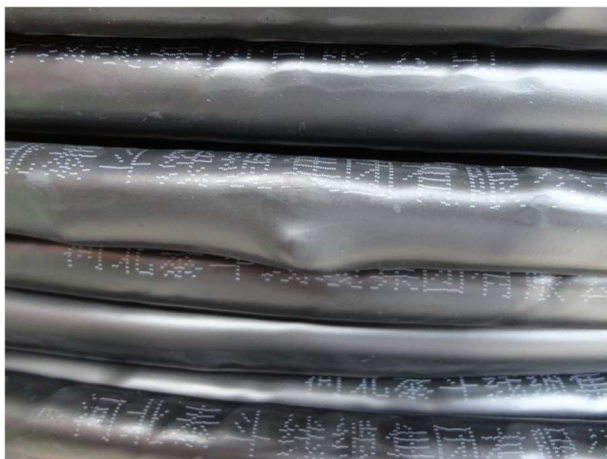
高压线缆材料中出现接头
