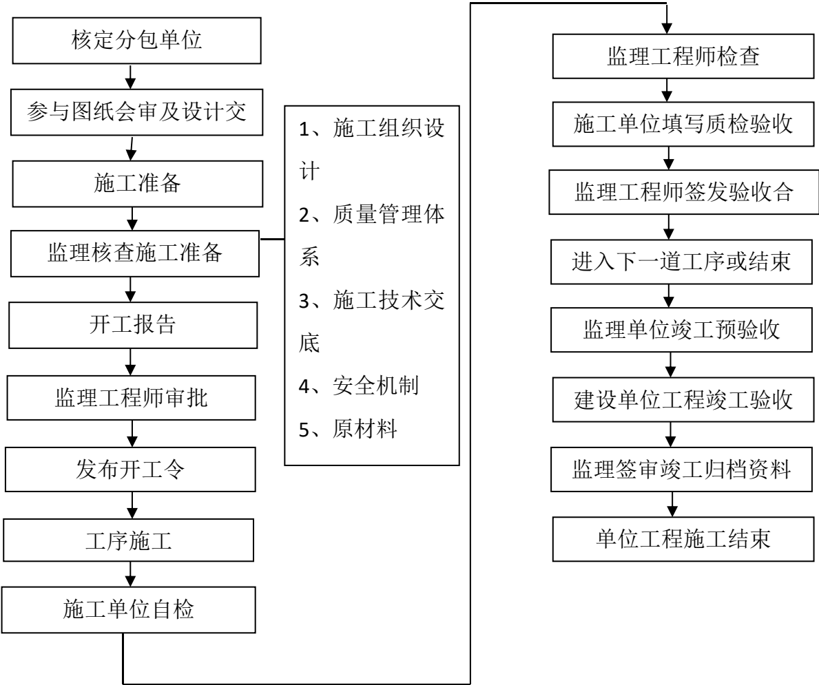
单位工程施工监理质量控制流程
