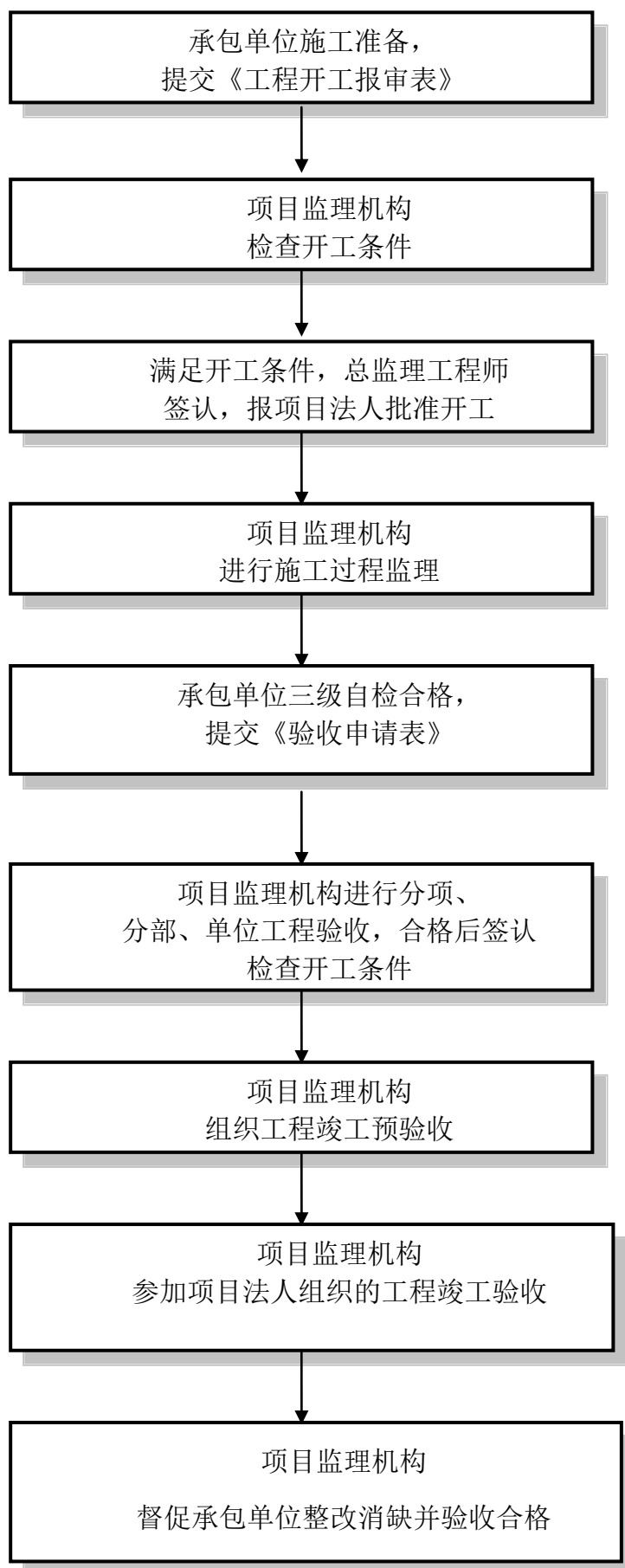
图 B.1 施工阶段工程质量监理程序框图
