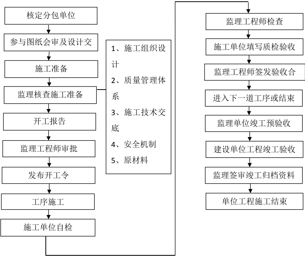
单位工程施工监理质量控制流程
