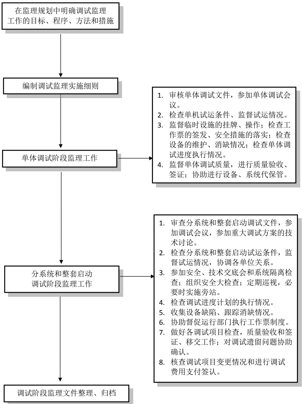
图 B.9 调试阶段监理工作程序框图
