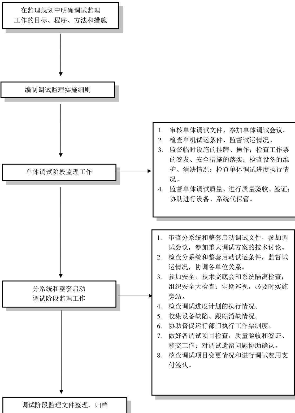
图 B.6 调试阶段监督工作程序框图
