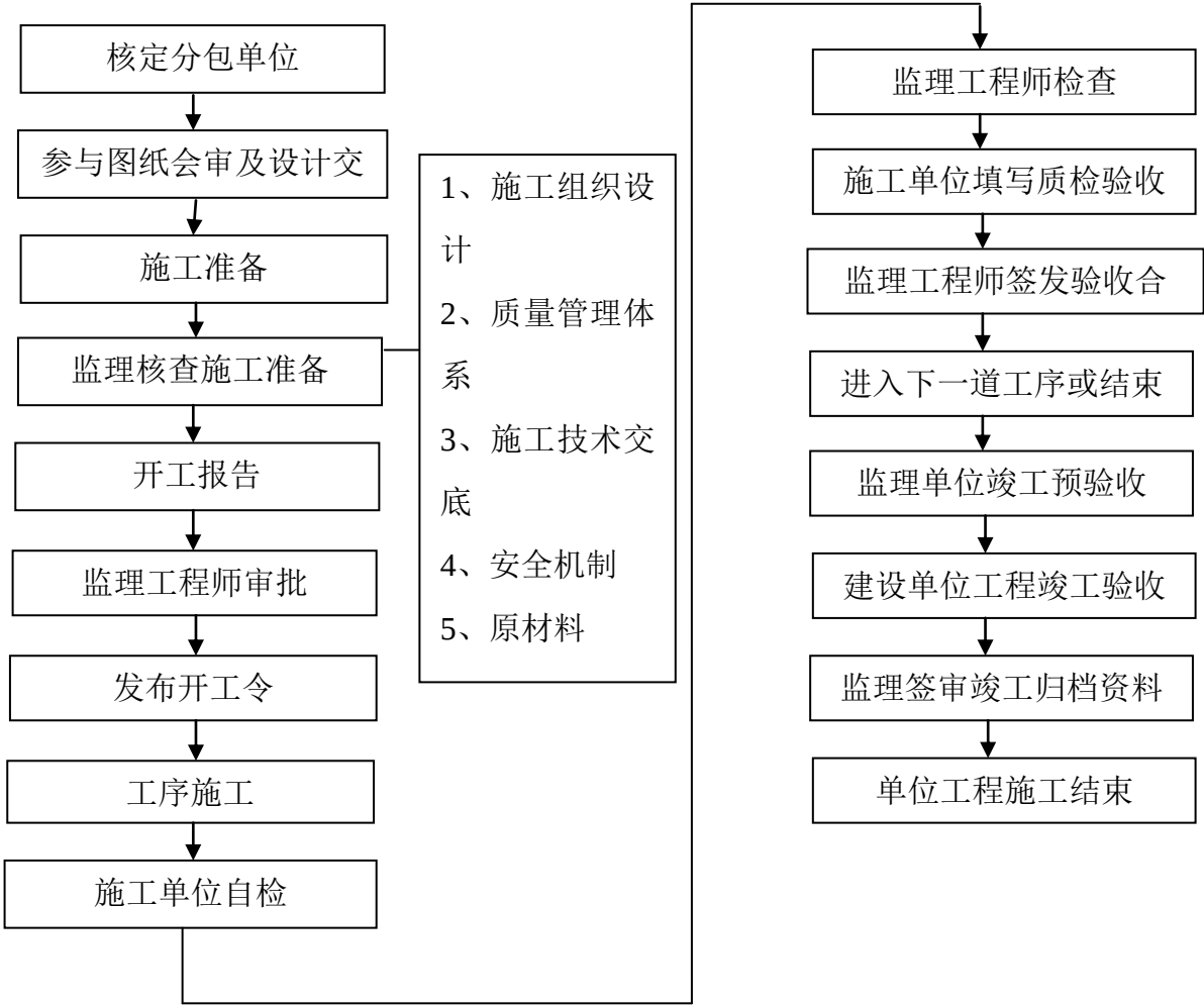
单位工程施工监理质量控制流程
