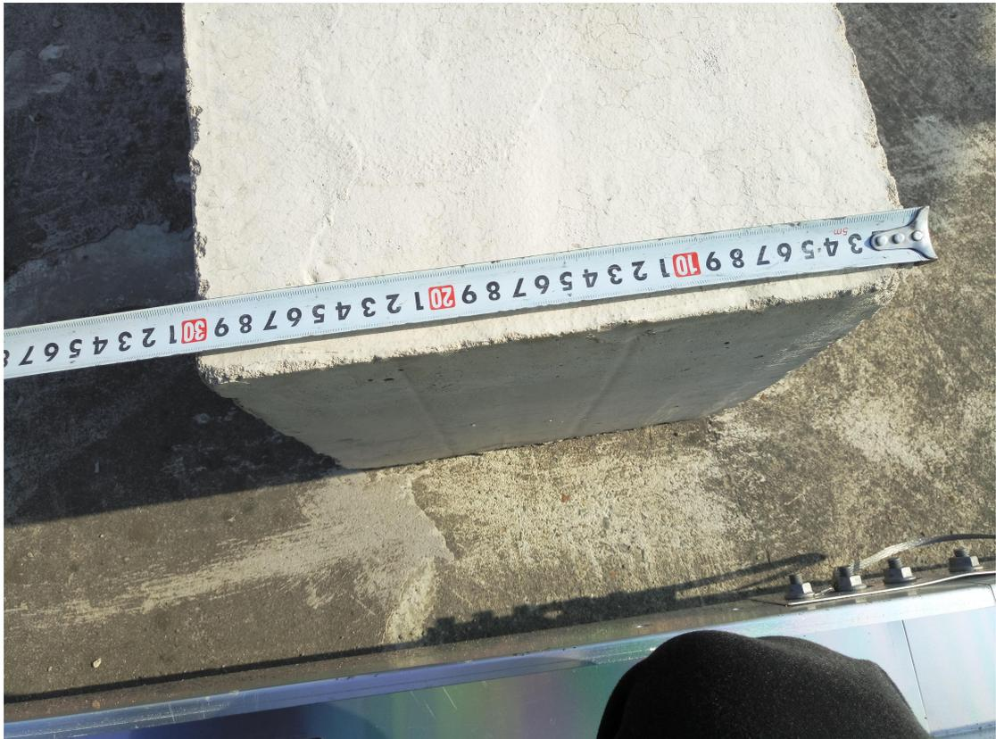
实际测量前立柱基础尺寸为(300\*300\*280 不符图纸 500\*500\*300 要求, 单位 mm)
