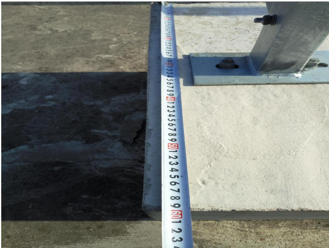
实际测量后立柱基础尺寸为(300\*600\*280 不符图纸 500\*500\*300 要求, 单位 mm)
