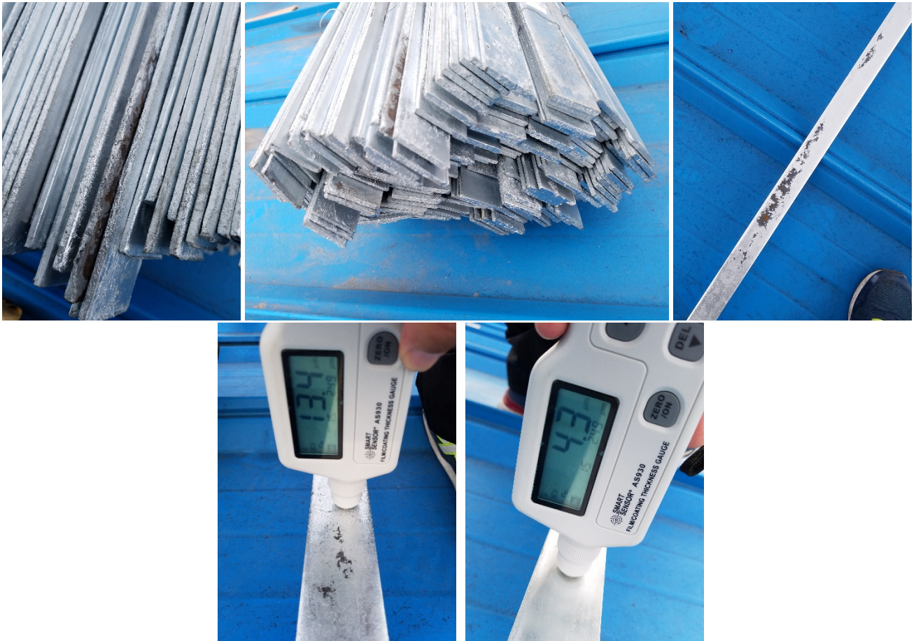
防雷接地扁钢及其镀锌层厚度测试
