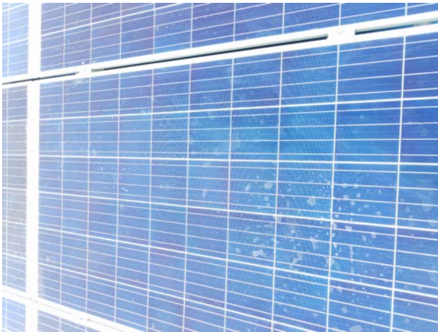
组件中间按压痕迹（手印）
