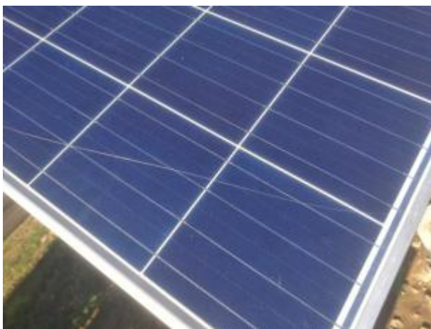
组件板面上有划痕、防水皮套安装位置错误
