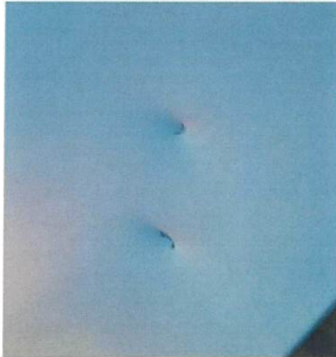
0701逆变器箱门外观破损。
