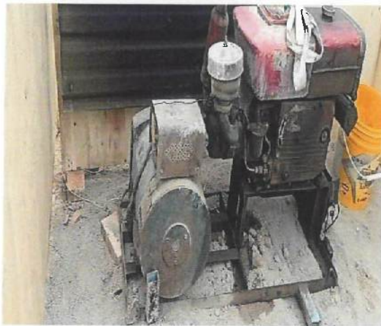
29. 加工区域附近摆放的柴油电机已接地
