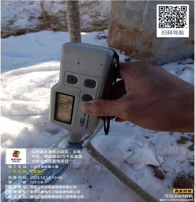
侯家寨大棚柱上变接地扁铁镀锌层厚度及搭接长度不符合设计、规范要求
