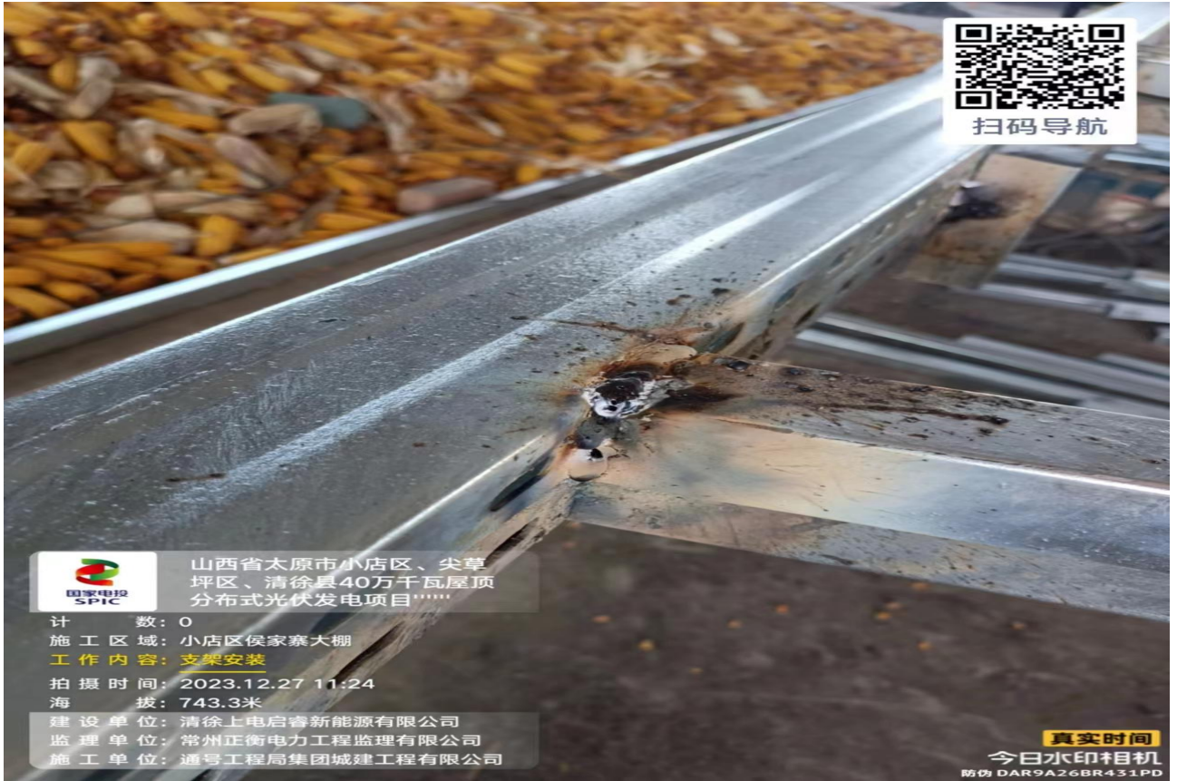
支架焊接加工有气眼、灼伤材料问题
