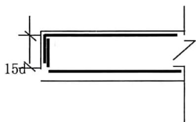
(15) 剪力墙墙厚变化时钢筋搭接: (详结施-2 结构设计总说明)
