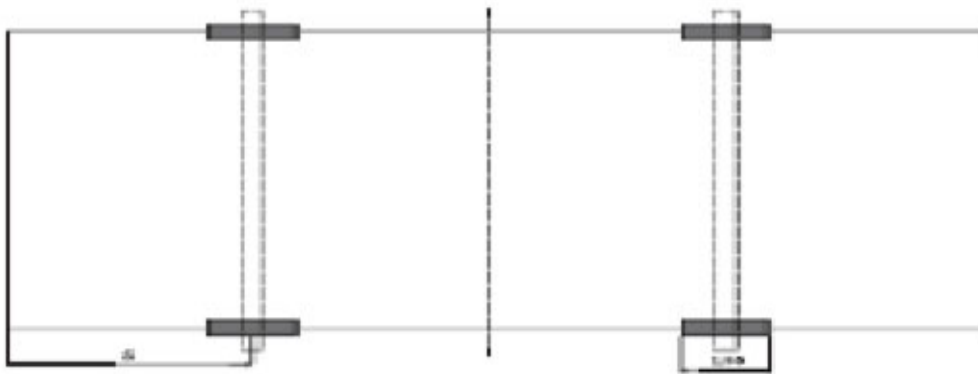
无框组件压块安装 (压块长度 = 150mm)
