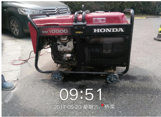
发动机漏油，污染地面
