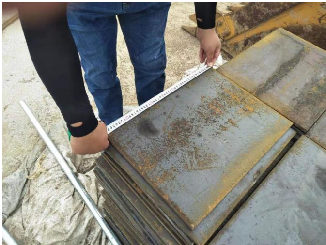
地脚螺杆锚板厚度测量 (图纸 16mm, 实测 13.5mm)
