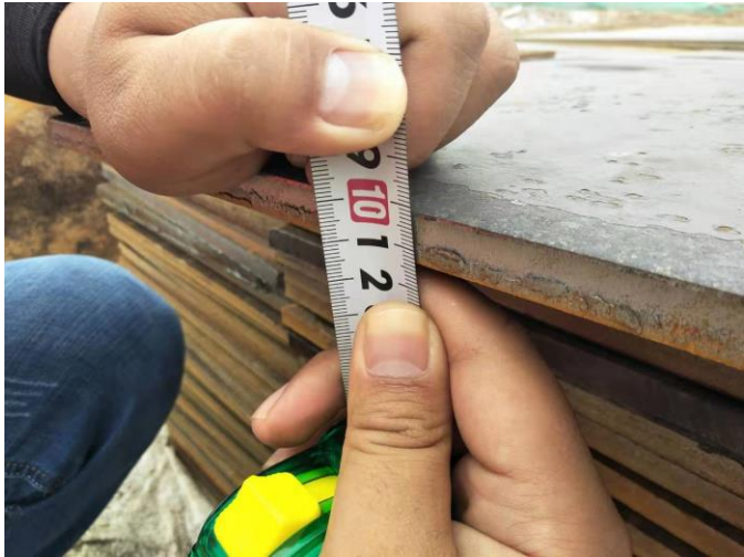
地脚螺杆锚板厚度测量 (图纸 16mm, 实测 13.5mm)
