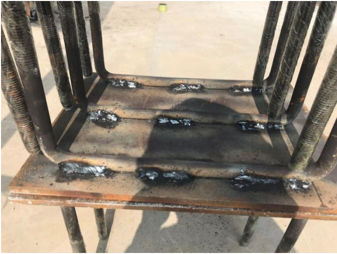
地脚螺栓和锚板之间的焊接与图纸求不一致
