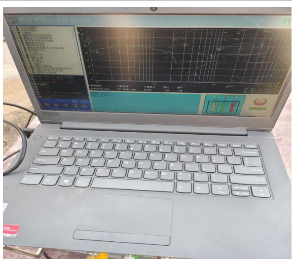
主变套管 ct 变比试验
