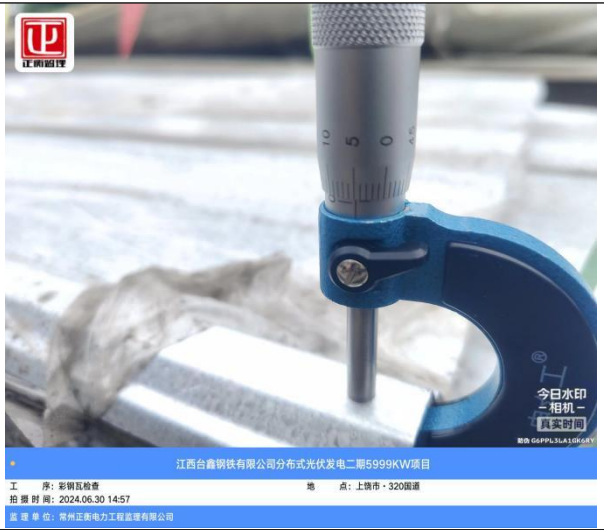
彩钢瓦厚度检查符合图纸设计
