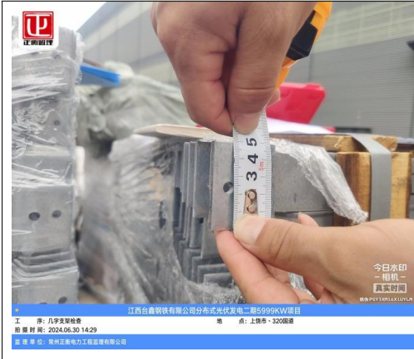
主水槽宽度检查
