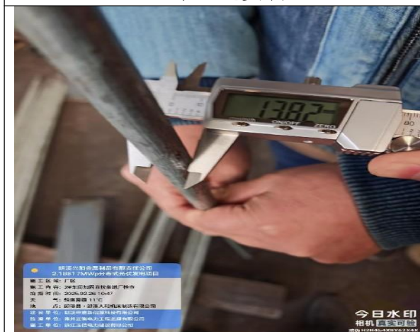
2#车间加固直拉条材料检查
