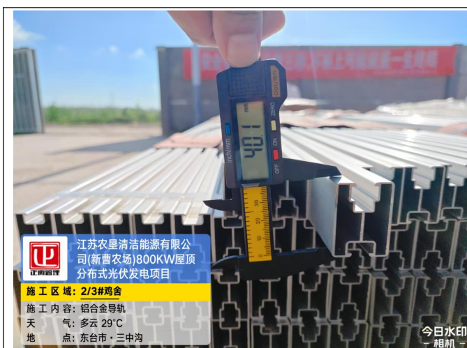
平行检验导轨材料进场，符合设计要求
