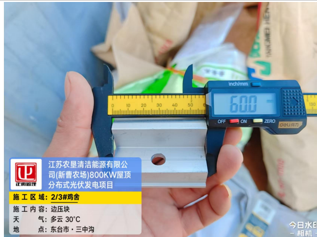
平行检验边压块材料进场，符合设计要求
