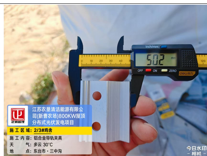
平行检验夹具材料进场，符合设计要求
