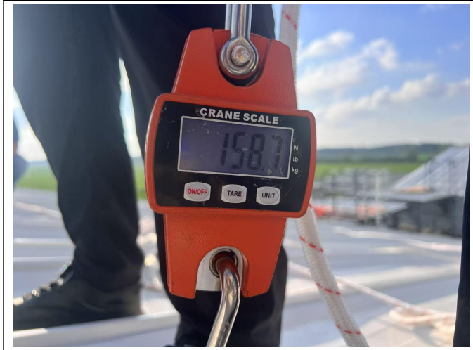
2#鸡舍夹具拉拔试验，符合设计要求
