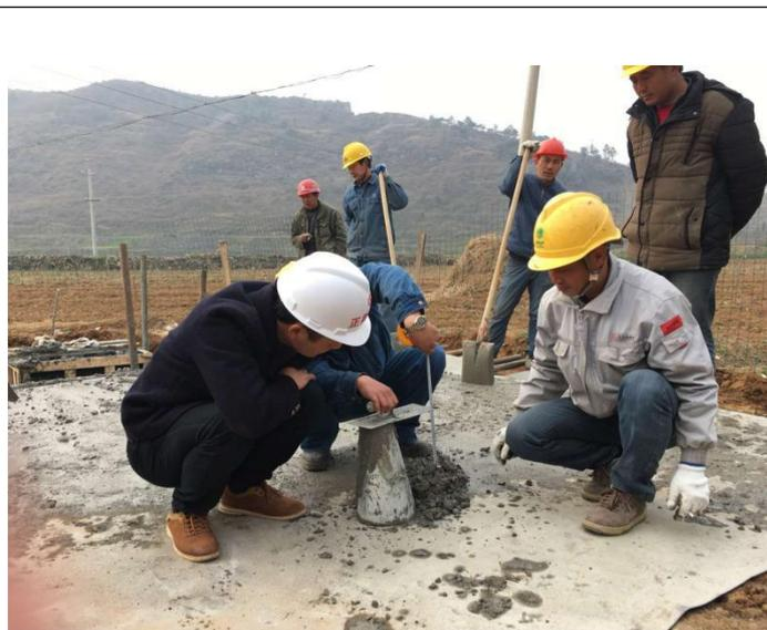
外线铁塔基础 T15 基础混凝土坍落度验收
