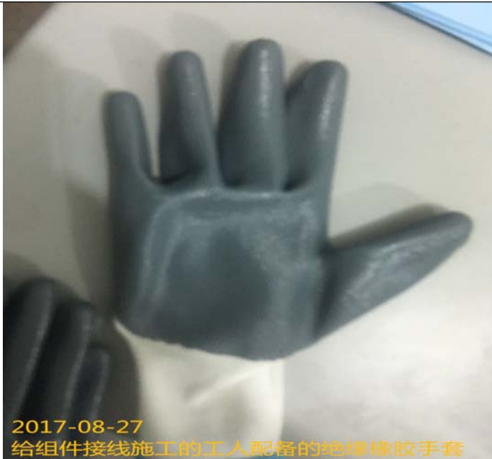
11、给组件接线施工的工人配备的绝缘橡胶手套
