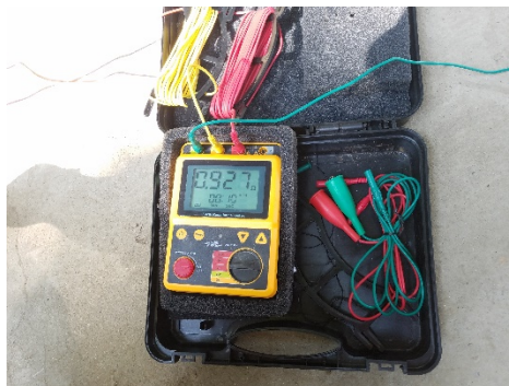
06 设备接地电阻值测试
