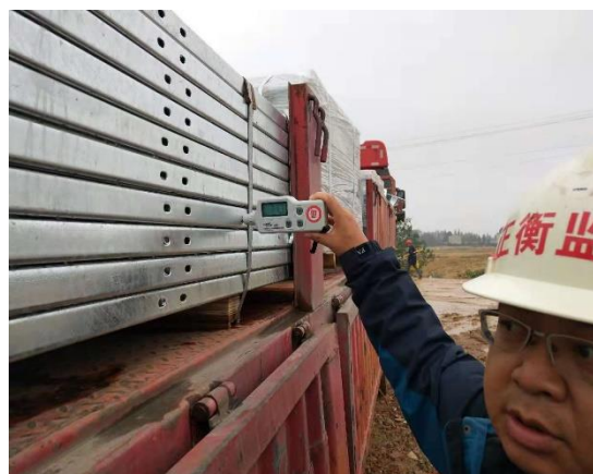
检测支架镀锌层厚度 ( 66-86\text{ }\mu\text{m} 符合要求)
