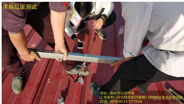
屋面夹具拉拔试验
