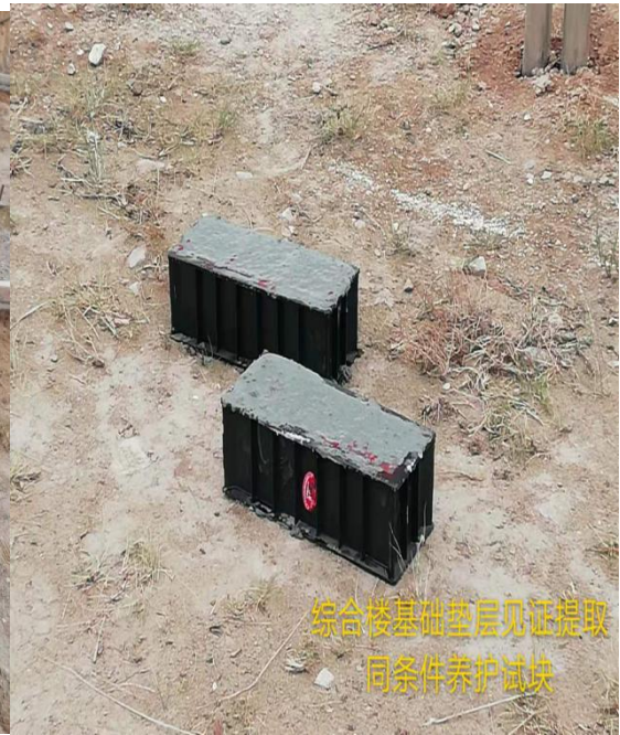
综合楼基础垫层见证提取同条件养护试块
