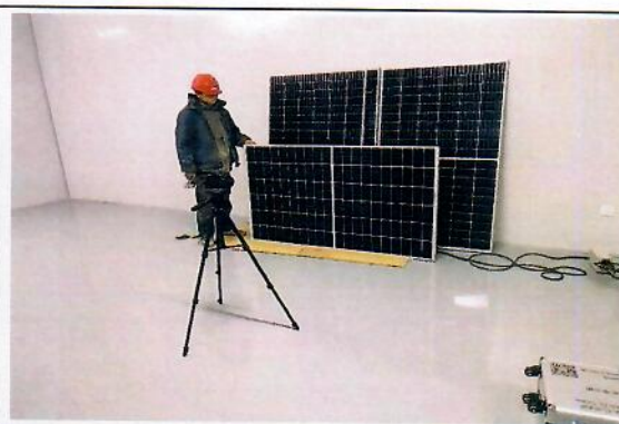
光伏组件做隐裂试验
