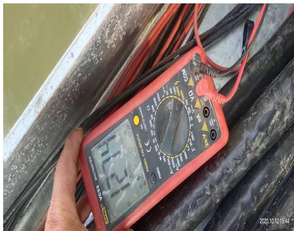
测试 94#、95#箱变区域逆变器安装开路电压
