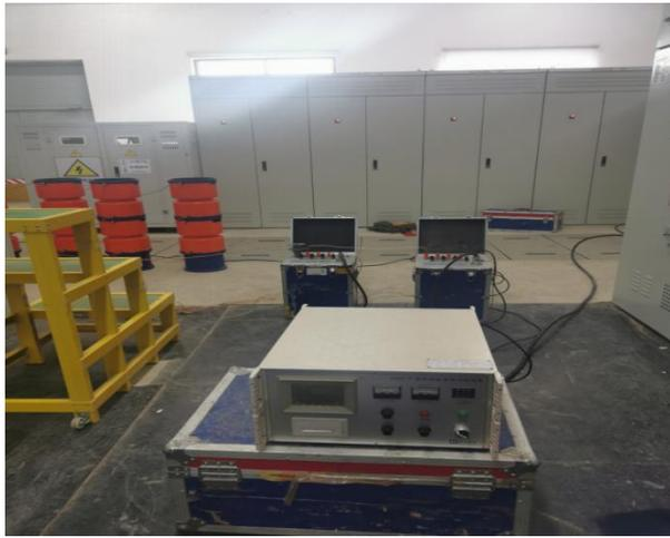
电缆打压试验
