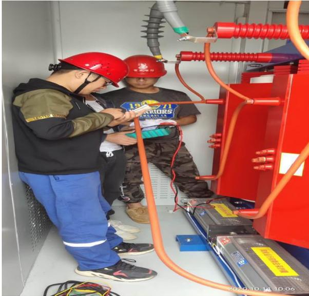
现场 91#、93#、94#箱变变比、直阻测量和绝缘试验测试
