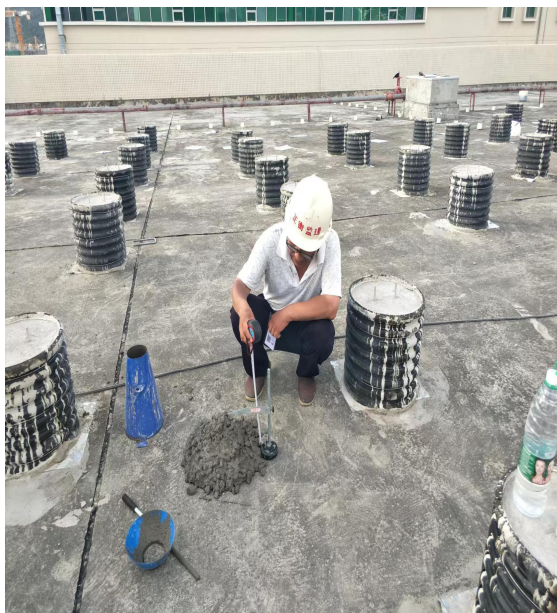
混凝土塌落度检测
