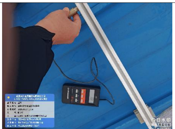
材料阳极氧化膜检查
