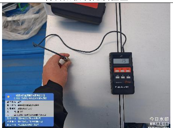
材料阳极氧化膜检查
