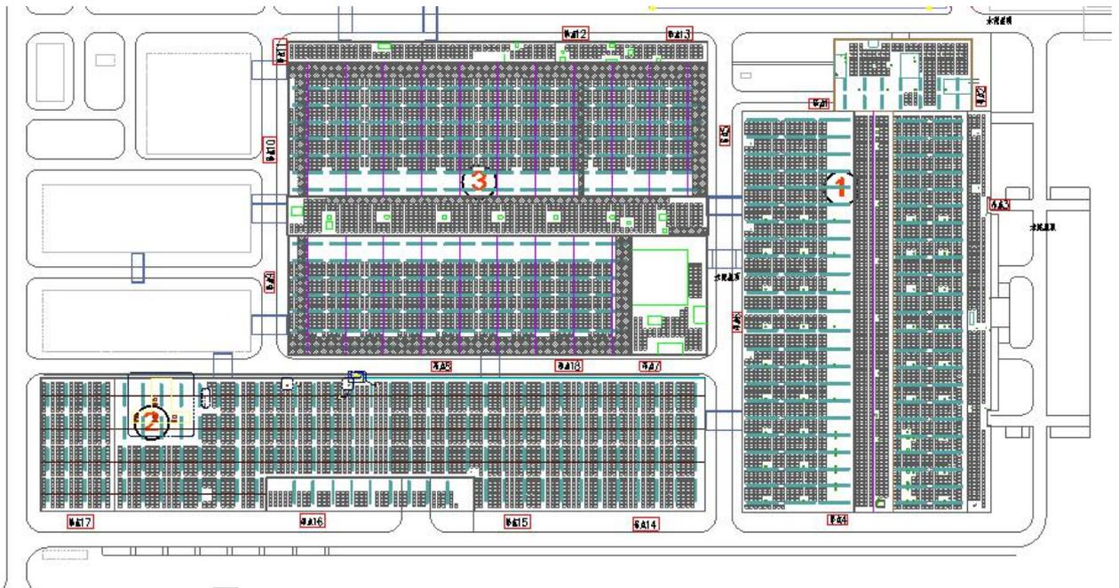
每件组件重25.9KG, 每件组件的规格为1956\*992mm, 折算组件载荷为13.3KG/m<sup>2</sup>, 加上光伏支架重量, 安装光伏系统需要屋顶载荷为15-18KG/m<sup>2</sup>。
