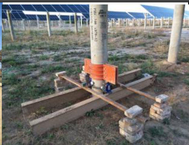
PHC桩静载试验
