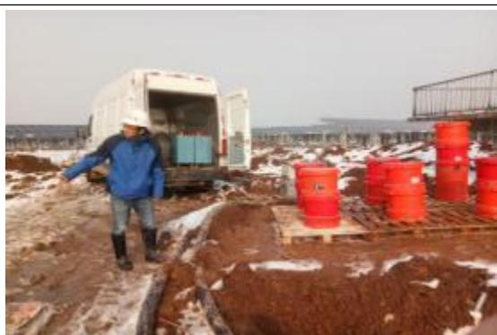
二期 5 号集电线路耐压试验
