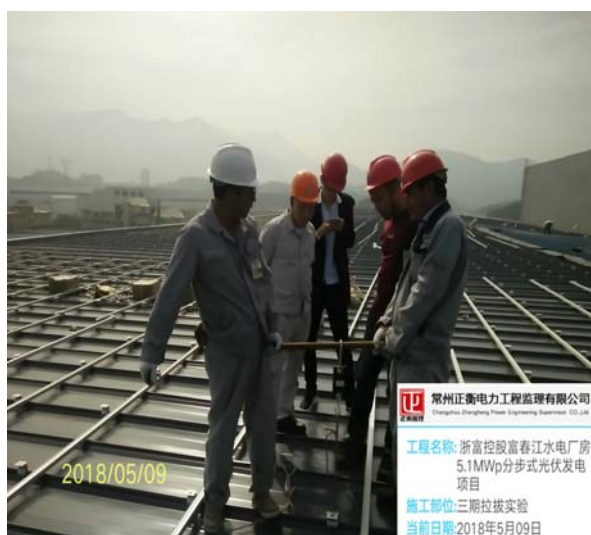
夹具拉拔实验
