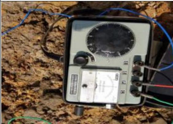
外线20号铁塔测量防雷电阻
