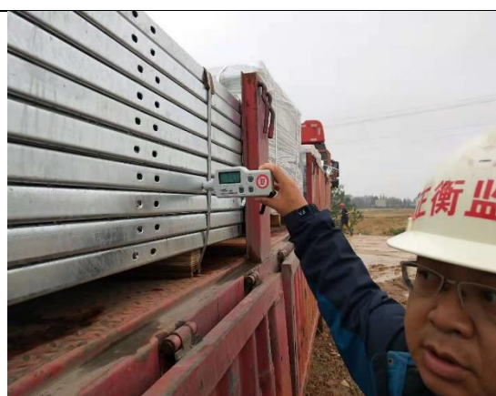
检测支架镀锌层厚度 (57-86 \mu\text{m} 符合要求)
