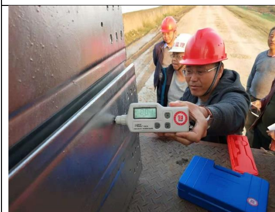
桥架到货检测镀锌层厚度 (71-89 \mu\text{m} 符合要求)
