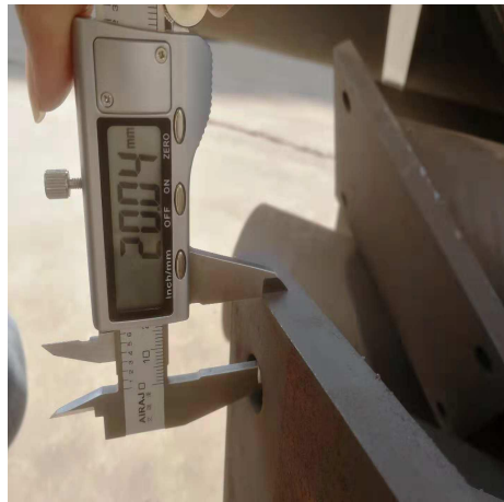
加固板开孔位置与设计图纸不符
