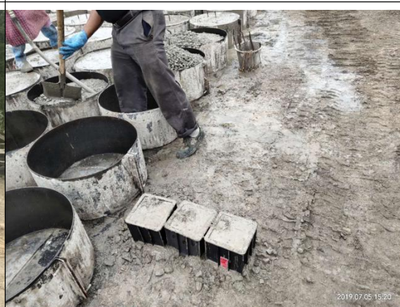
混凝土试件制作
