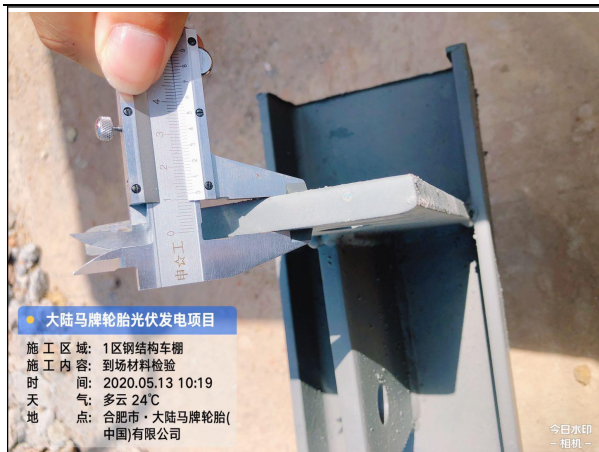
到场钢构检查
