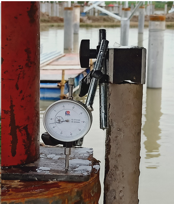
现场 A2 区 1678#桩静载试验
