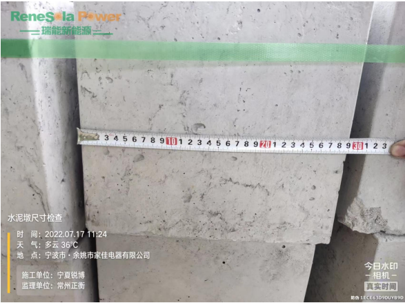
水泥墩尺寸检查
