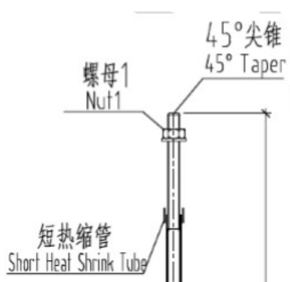
图 3.14 普通锚栓上端
